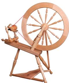
El torno de hilar mecánico se acciona a mano o pisando repetidamente un pedal. Al hacerlo hace girar el torno y retuerce la lana a medida que la enrolla en el huso. Una correa pasa por una rueda
